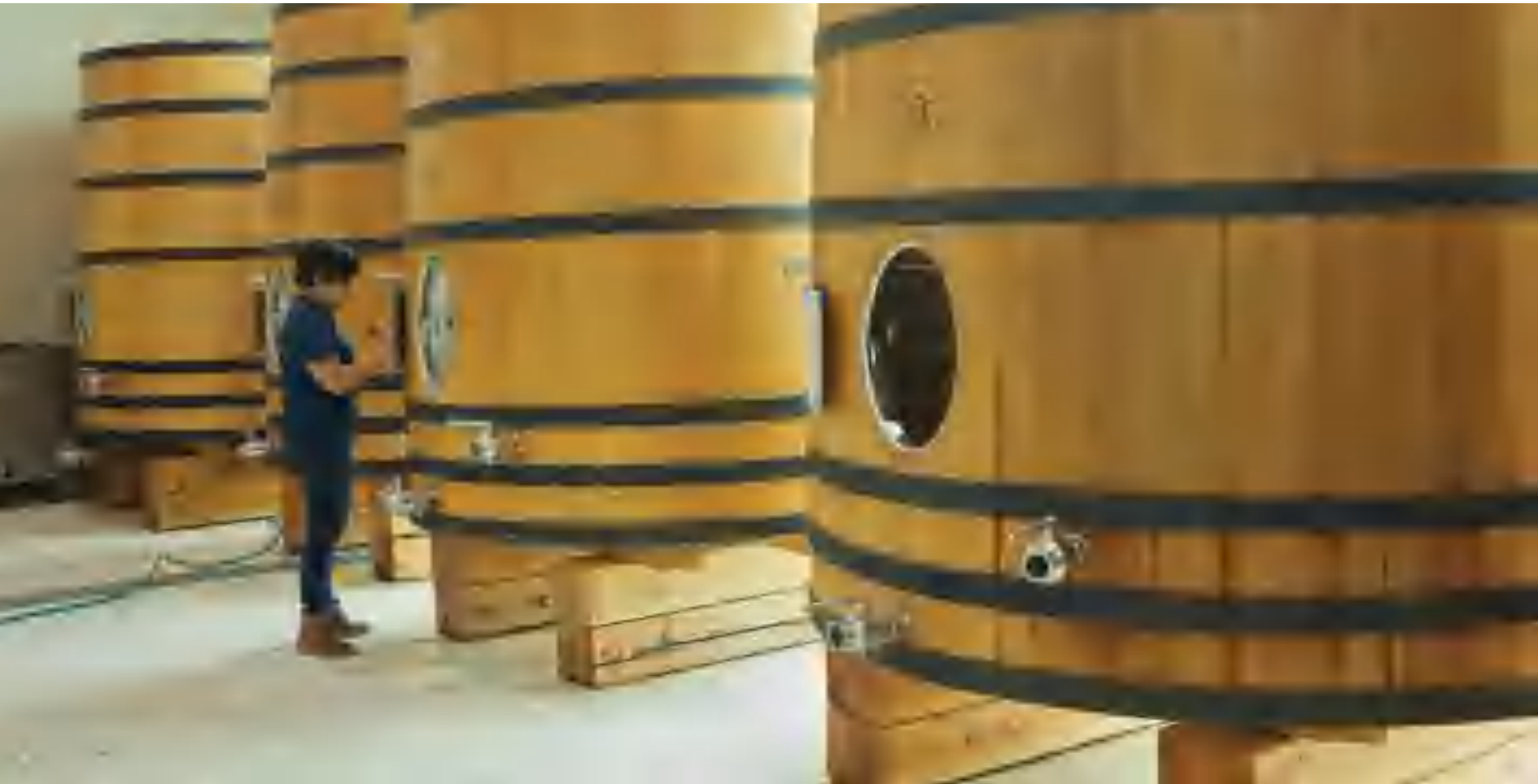
Fudres de roble blanco para fermentación del mosto en la bodega Tres Raíces. Dependiendo del tipo de vinos, el enólogo puede elegir fermentar en depósitos de acero inoxidable o en madera.
